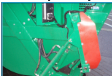
Utv. monterad hydraulslang
