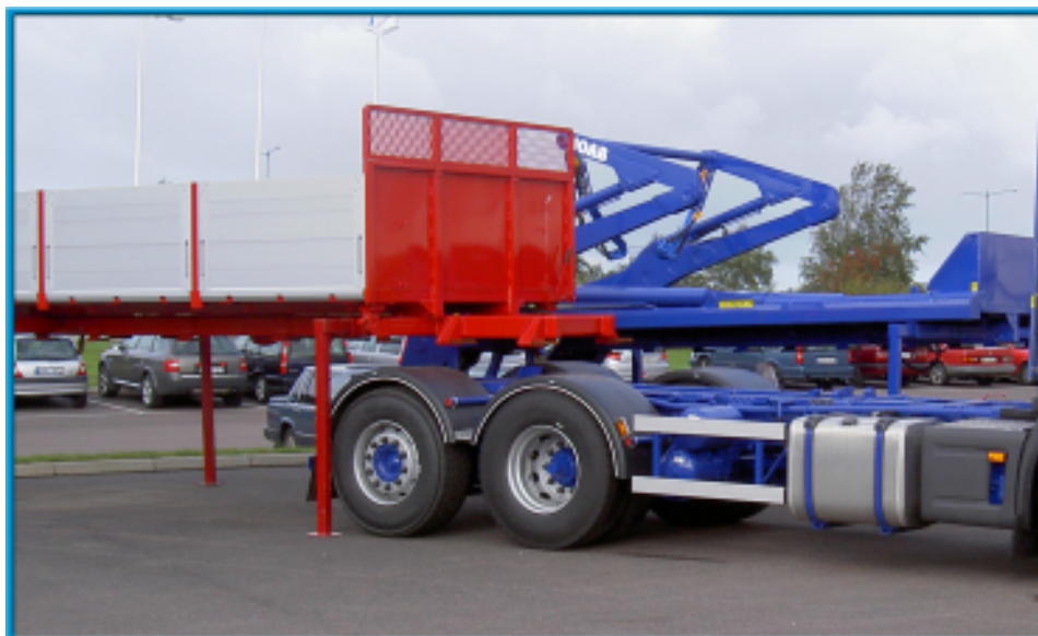
Hydraulisk framdragning och låsning
